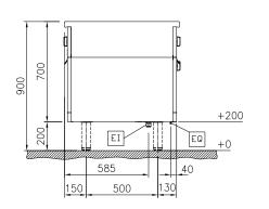
Electrical inlet (power) Equipotential screw
